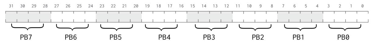
4 bits per GPIO pin
