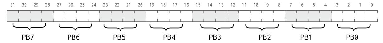
4 bits per GPIO pin
